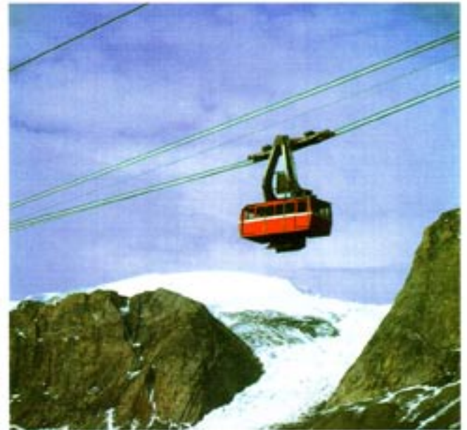
Ovenfor: Kabinelift ved Marmorilik, Grønland. Spænd 1,5 km. Mine nedlagt 1990.
